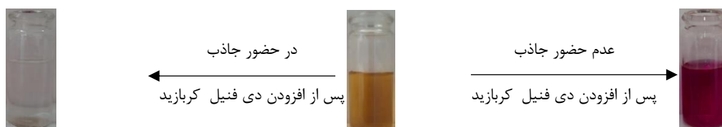
شکل ۲- تفاوت رنگ محلول کروم (VI) با دی فنیل کربازید در حضور و عدم حضور جاذب
