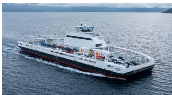
شکل ۳- کشتی ام اف آمپر، اولین کشتی حمل خودرو تمام الکتریکی
