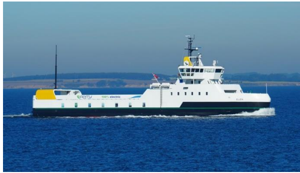
شکل ۴- کشتی الن، اولین کشتی تمام الکتریکی حمل خودرو-مسافر
